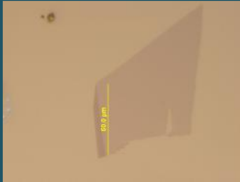
Imatge d'una capa individual de grafè fabricada per exfoliació
